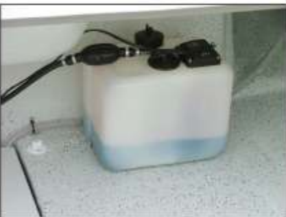
▲ Das Ölreservoir unter der Rückbank.
